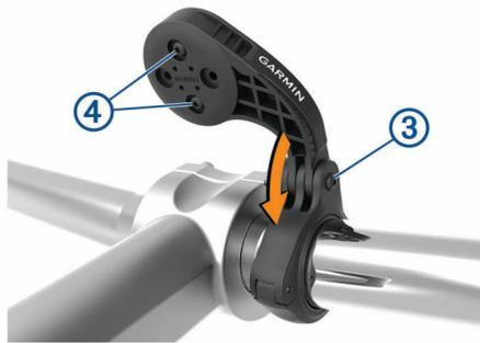
6 Lösen Sie bei Bedarf mit dem 2-mm-Inbusschlüssel die zwei Schrauben auf der Rückseite der Halterung ④, entfernen und drehen Sie das Verbindungsstück, und setzen Sie die Schrauben wieder ein, um die Ausrichtung der Halterung zu ändern.
