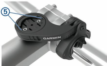
9 Drücken Sie das Edge Gerät leicht nach unten, und drehen Sie es im Uhrzeigersinn, bis es einrastet.
